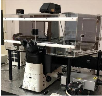
SIM技术是一种易操作的超分辨率成像技术，相比PALM/STORM技术和STED技术，SIM成像对荧光蛋白或分子要求少（常规荧光探针即可），时间分辨率高（可用作活细胞成像），荧光光子利用率高。
