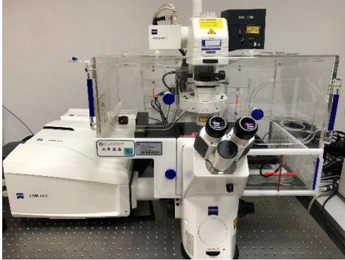
可用于组织切片、活细胞荧光标记、三维图像重建分析研究；细胞生物物质、离子的定性、定量、定时和定位分布检测等。
